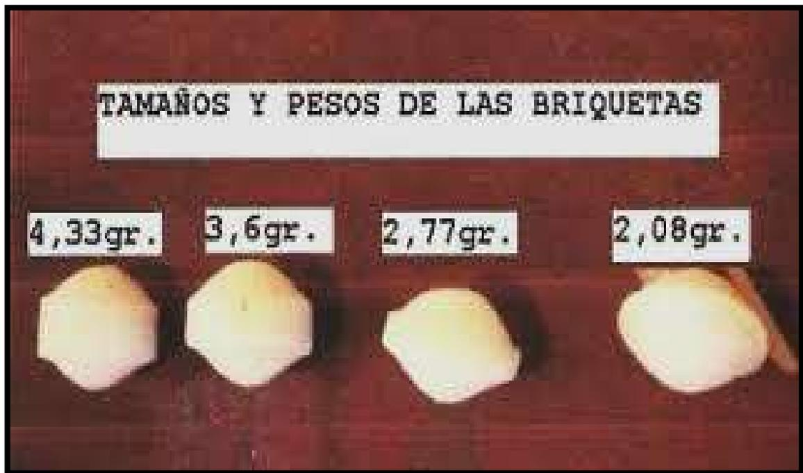
Figura 15. Briquetas en diferentes dosis con forma esférica
